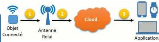
Un **objet connecté** est un objet électronique capable de communiquer avec un autre objet (souvent un smartphone, une tablette ou un ordinateur). Cette communication permet à l'objet d'envoyer ou de recevoir des informations via une connexion Internet.
