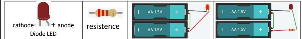
Une **diode électroluminescente**, ou LED pour "Light-Emitting Diode", est polarisée, elle ne s'allume que lorsque les pattes sont connectées dans un sens bien déterminé.
